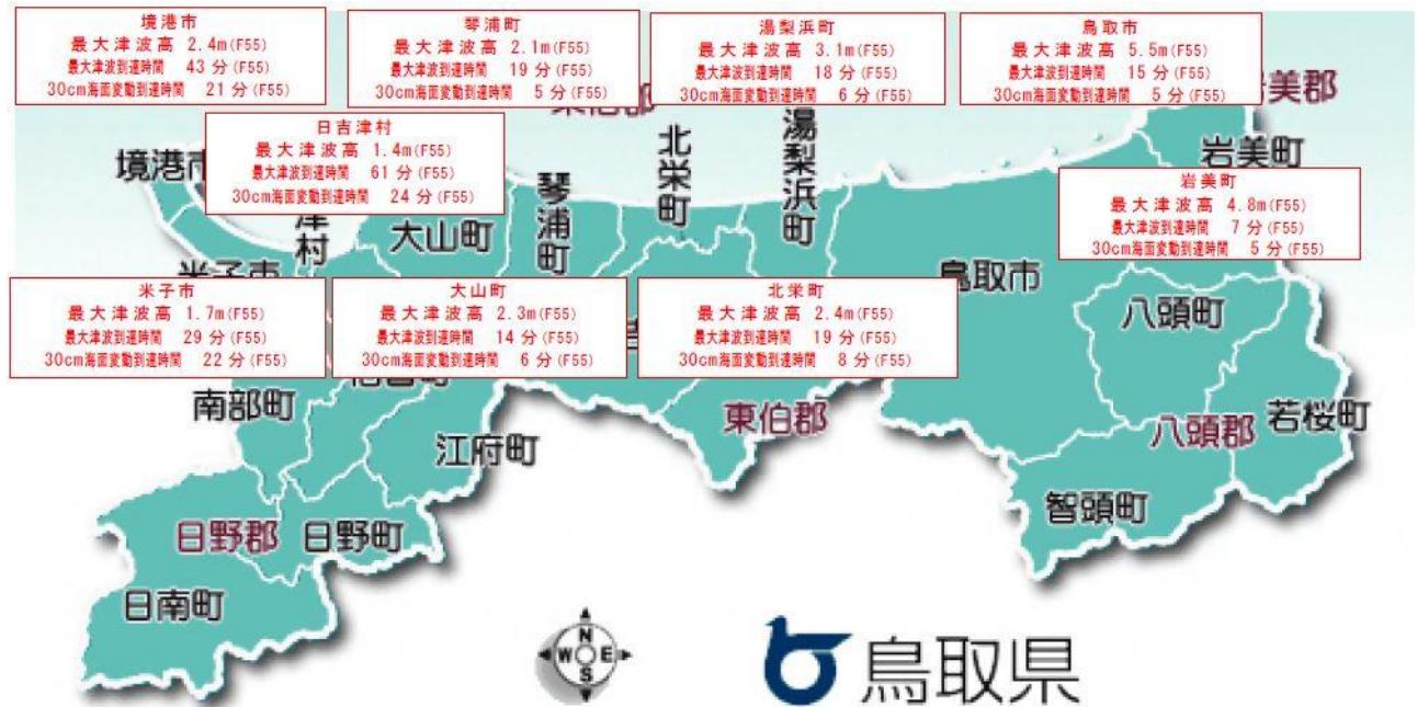
図 F55 断層モデルにおける最大津波高、最大津波到達時間、30 cm海面変動到達時間
