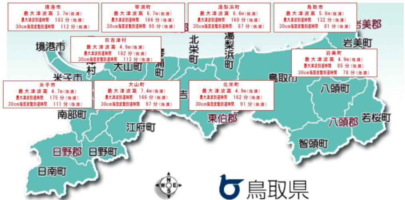
図 佐渡北方沖断層モデルにおける最大津波高、最大津波到達時間、30 cm海面変動到達時間
