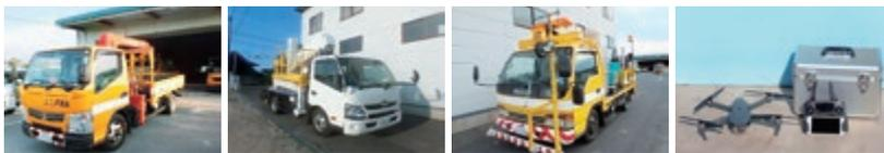
3tユニック車      橋梁点検車      ラインマーカー車      ドローン
