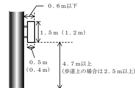
【図8-2】電柱に巻き付ける場合
