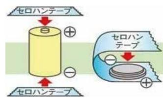
電池の端子（電極）がむき出しの場合、他の電池や金属に触れることでショートし、発熱・発火・破裂の危険があります。テープ等で絶縁処理をしてから出してください。
