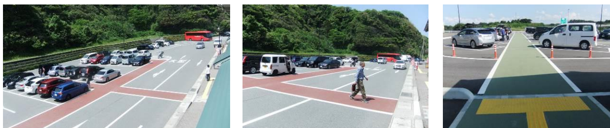
▲小型車と大型車の駐車スペースを分離し、カラー舗装によって歩行者動線を明確にした事例
