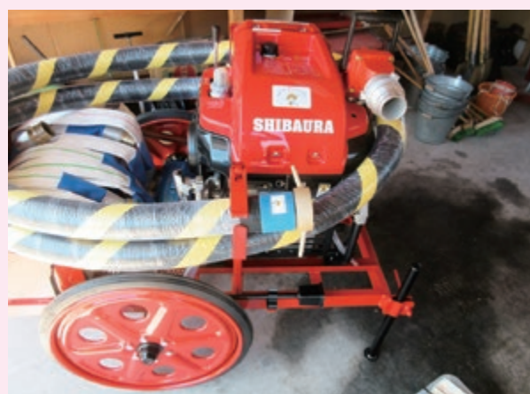
整備された小型消防ポンプ
