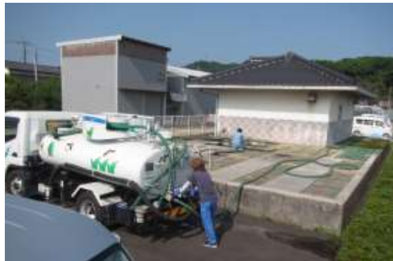
農業集落排水事業の処理施設クリーンセンター島から処理した汚泥を年間3回程度、一般廃棄物として中部クリーンセンター（し尿処理場 倉吉市小田）へ運搬
